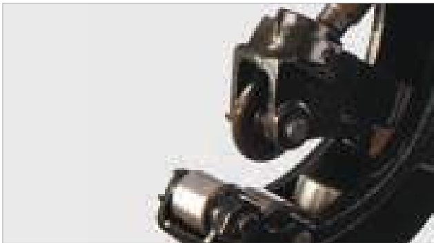
Встроенный труборез со сменным диском
